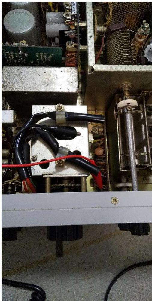
左の写真の赤いワニ口クリップで接続されている所にHFOを注入します。
