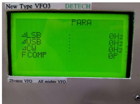
次にキースイッチ **ENTER** を押すと左図のような画面に遷移します。ΔLSB、ΔUSB、ΔCWは夫々LSB、USB CWのキャリア・ポイント補正值を設定します。FCOMPはDDSのマスター・クロックの補正です。
